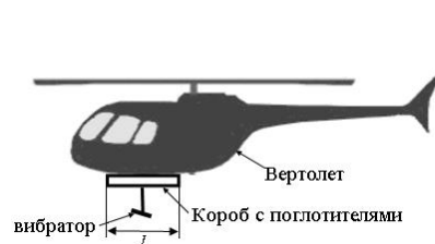
Рис. 7. Конфигурация системы “вертолет–короб–вибратор”
