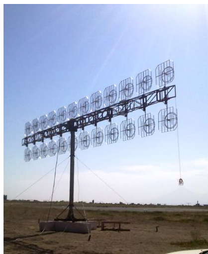
Рис. 11. Макет антенной решетки на летном поле
