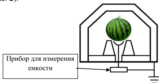
Рис. 2. Электрический метод измерения емкости
