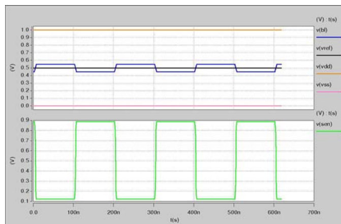
Рис.6. Временные характеристики усилителя во время цикла считывания
