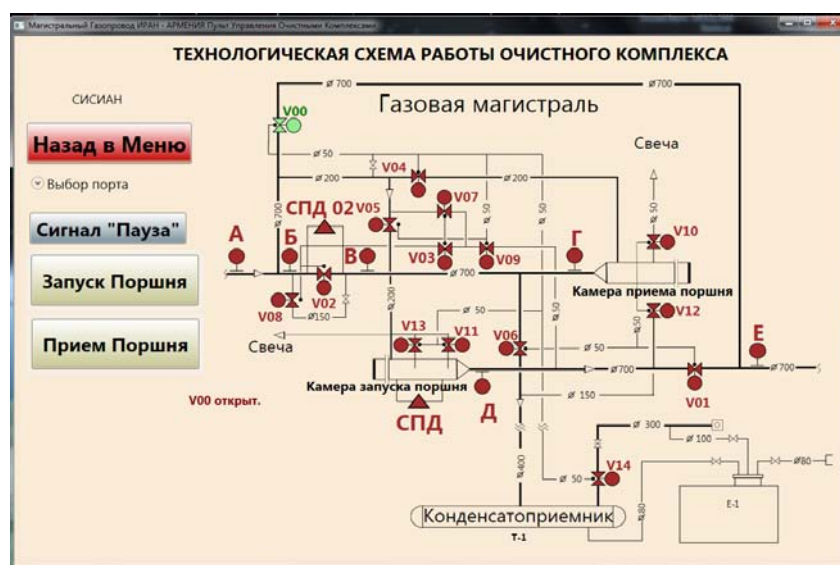
Рис.1. Технологическая схема (мнемосхема) работы очистного комплекса газовой магистрали
