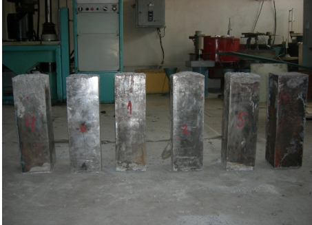
Նկ. 2. Ուղղանկյուն կտրվածքով խողովակաբետոնի նմուշները
