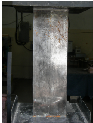
Նկ. 5. Խողովակաբետոնի սեղմման ենթարկված նմուշը
