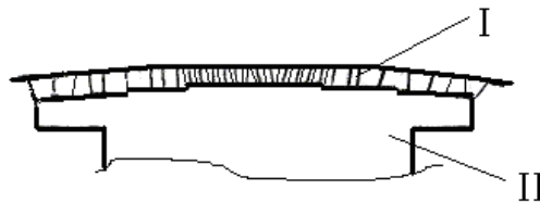
Նկ.4. Էլեկտրահաղորդիչ թղթի վրա մոդելավորման եղանակով ստացված մագնիսական դաշտի պատկերի հատված՝ \delta=2,6 մմ օդային բացակով հիդրոգեներատորում:
