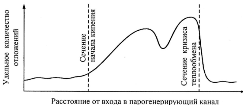
Рис.1. Распределение удельного количества отложений \Delta в вертикальном парогенерирующем канале в зависимости от условий теплообмена
