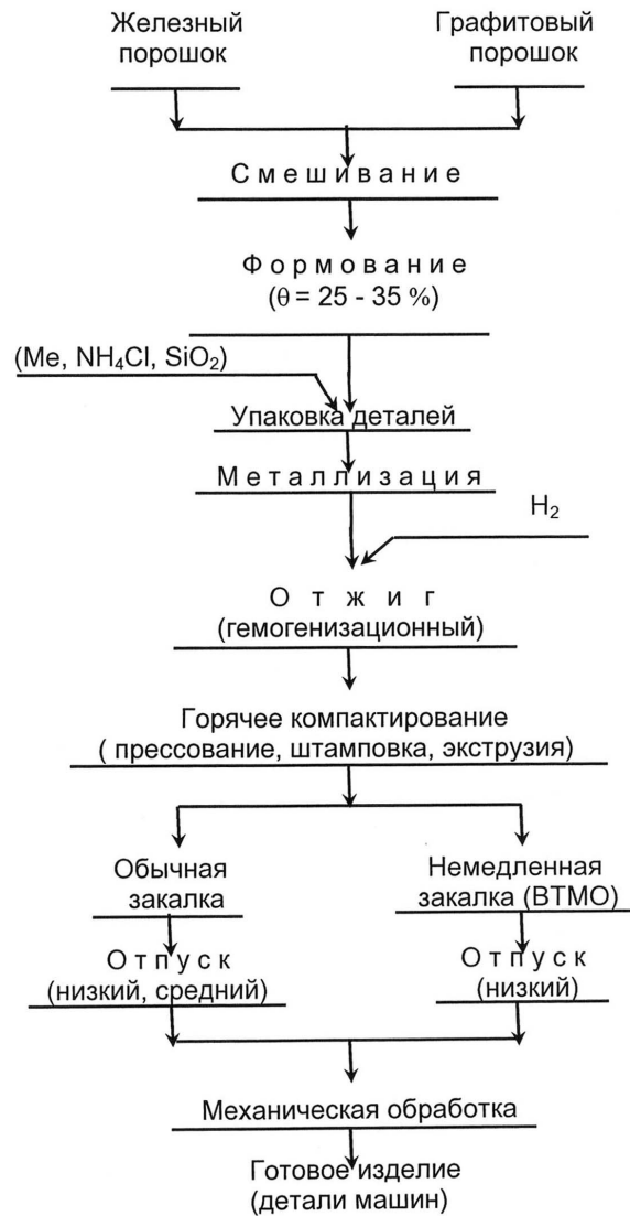
Рис. 7. Технология получения поверхностно-легированных порошковых деталей металлизацией
