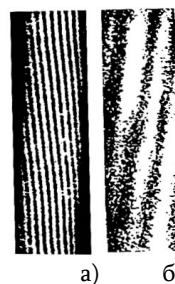
Рис. 2. Интерферограммы от двукратного двухкристального интерферометра: а – отражение (220), б – отражение ( 2\bar{2}0 )
