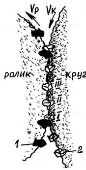
Рис.2. Схема контактирования алмазного ролика с шлифовальным кругом :
