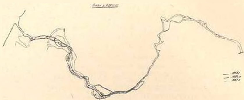
Рис. 2. План русла реки в зависимости от перемещения базиса эрозии
