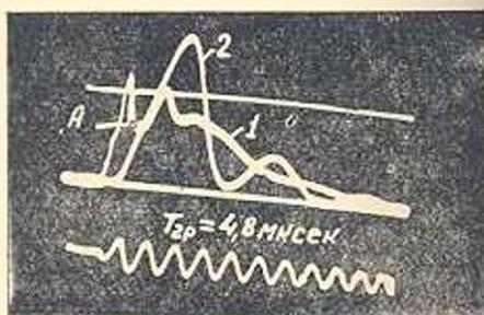
Рис. 6. Осциллограммы волны напряжения в начале (1) и в конце (2) 3,0 кв кабеля (230 м кабеля лежит на земле, 260 м намотано на барабан). В точке А на кривой „1“ волна отражается вследствие индуктивности кабеля, намотанного на барабан.
