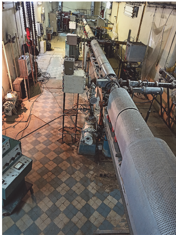
Рис.2. Ускоряющие секции ЛУЭ-75.
