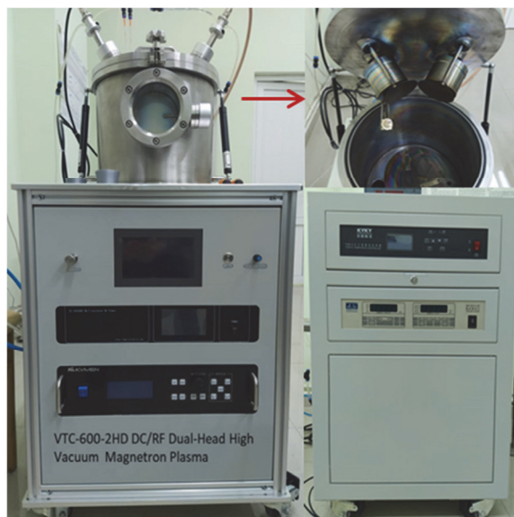
Рис.1. Система магнетронного распыления «VTC-600-2HD DC/RF Dual-Head High Vacuum Magnetron Plasma System».
