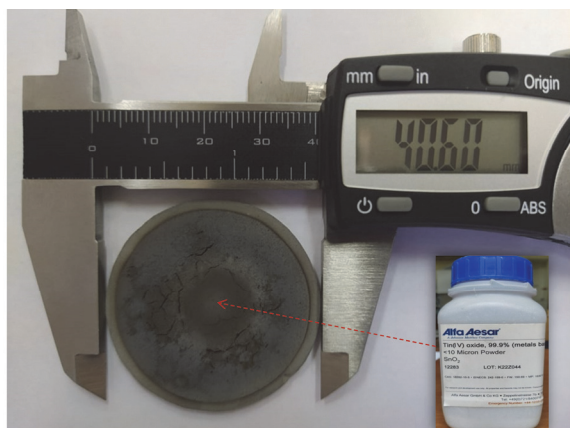
Рис.1. Керамическая мишень \text{SnO}_2\langle\text{Nb}\rangle , полученная на основе металлооксидного \text{SnO}_2 (Alfa Aesar) порошка.
