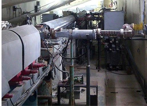
Рис.1. Ускоряющие секции линейного ускорителя ЛУЭ-75.
