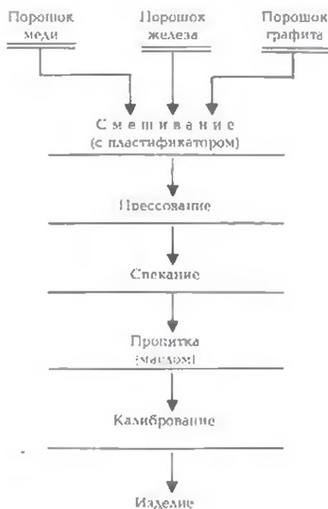
Фиг. 1. Технологическая схема получения железобитуминозных изделий [1]
