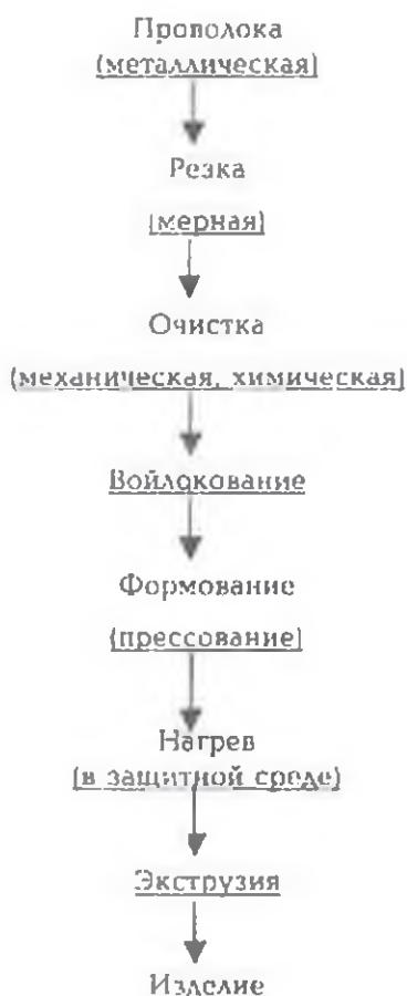
Фиг. 1. Схема технологии изготовления волокнистого материала
