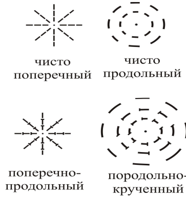
Рис.2. Дисклинация Франка силы s = 1 для случаев чисто поперечного и чисто продольного изгибов. Верхние две фигуры показывают невозмущенные распределения, а нижние – возможную релаксацию директора в третье измерение.
