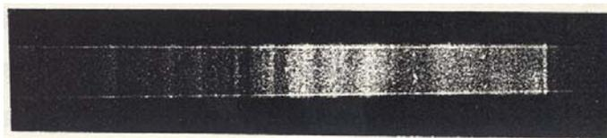
Рис.6. Топограмма, полученная узким лентообразным падающим пучком при непрерывном сканировании.
