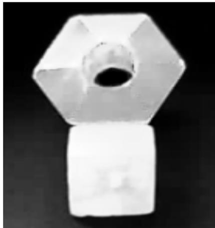
Рис.3. Профилированный монокристалл йодата лития.
