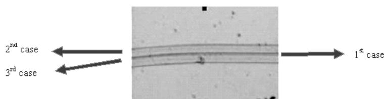
Рис.3. Изображения полупроводникового оптического усилителя (700(300 мкм) со структурой изогнутого волновода, полученные с помощью оптического микроскопа.
