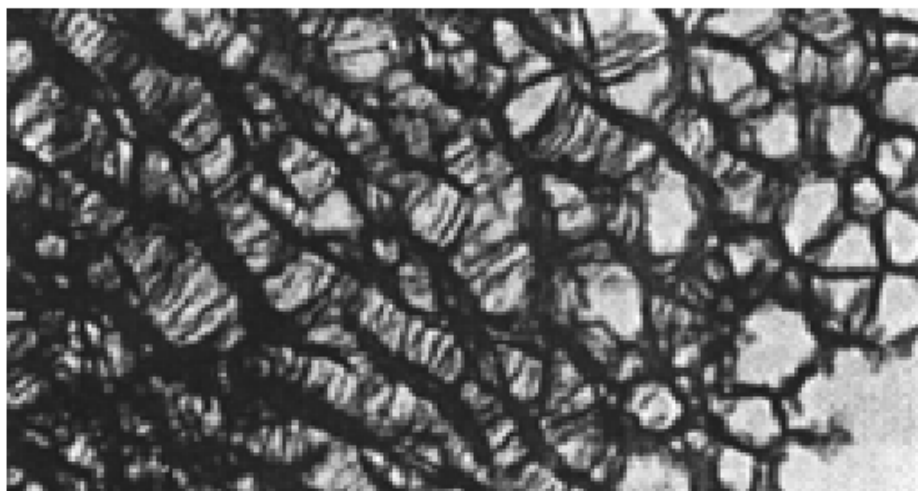
Рис.1. Изображение структуры пористого кремния на \rho -Si, полученное на просвечивающем электронном микроскопе. Размеры пор составляют около 50 нм, а кремниевые нити (темные области) имеют диаметр менее 10 нм
