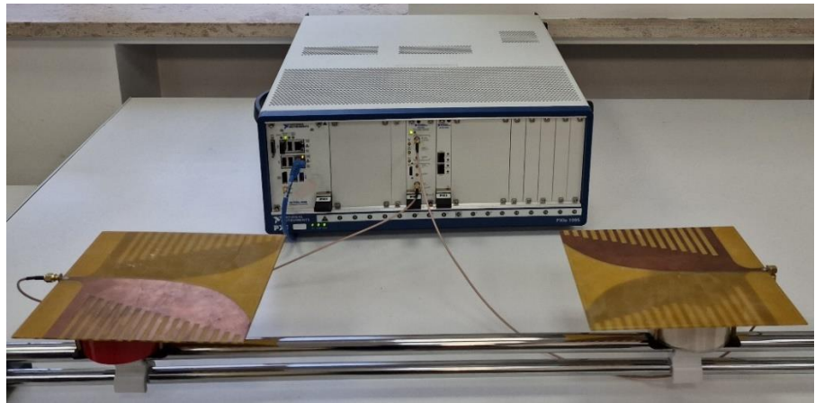
Рис.4. Система обнаружения и распознавания цифровых модулированных сигналов на базе PXIe-5841
