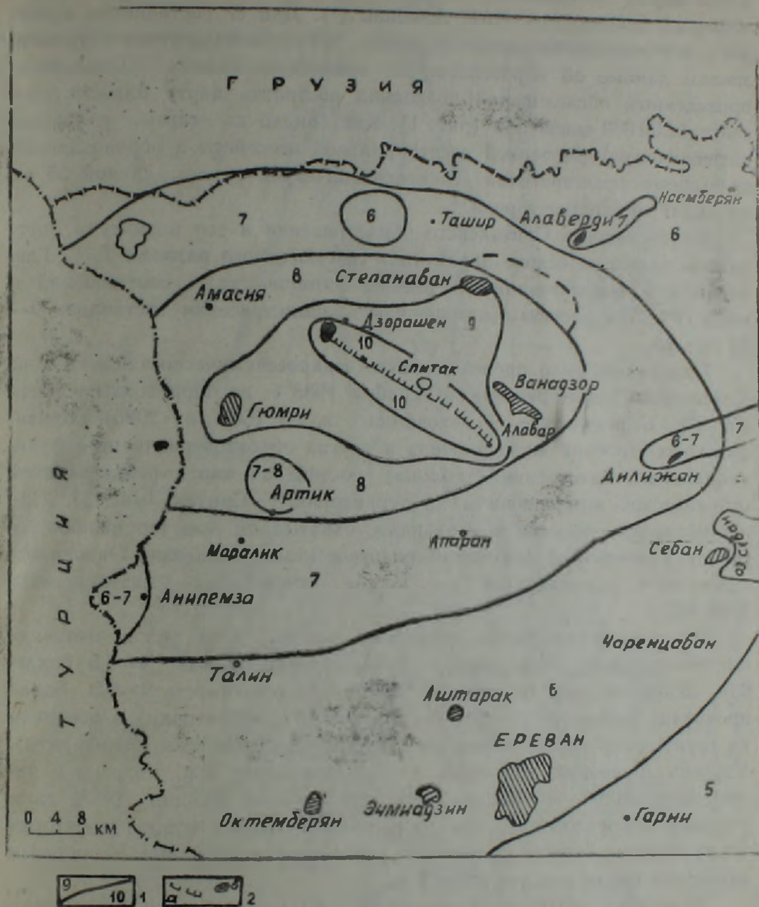
Рис. 1 Карта близких изосейст Спитакского землетрясения 7 декабря 1988 г. (1); 1 — изосейсты; 2 — образовавшийся на земной поверхности сеймотектонический разлом
