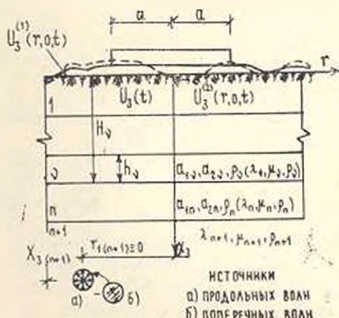
Фиг. 1. Расчетная схема круглого штампа на многослойном, неоднородном основании.
