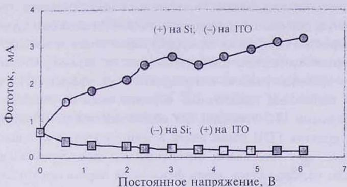
Рис. 5. Абсолютные значения фототока через структуру ГРПЖК при освещении монохроматическим светом с длиной волны 800 нм ( $T=300\text{K}$ ).
