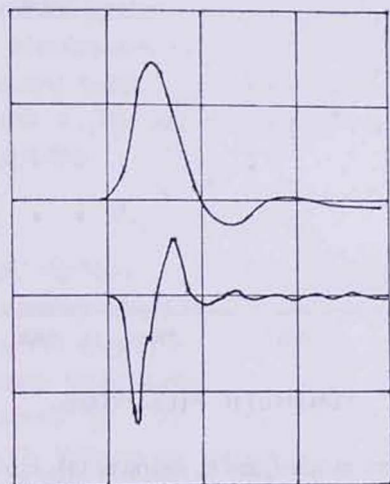
Рис.1. Схематическое изображение осциллограмм лазерного импульса и сигнала э.д.с. при N=8 \cdot 10^{12} \text{ см}^{-3} и H=0 . Масштаб по оси времени – 50 нсек /дел и по оси ординат – 10 мВ/ дел.
