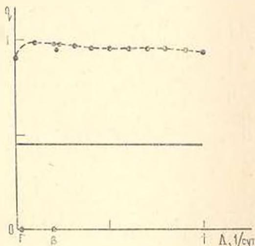
Фиг. 3. Зависимости малого параметра при разрыве бетона ( $\nu = 1$ ,  $\nu' = 0,1$  1/сут,  $t = 50$  сут) от скорости деформирования в линейной области (—) и нелинейной области (---)
