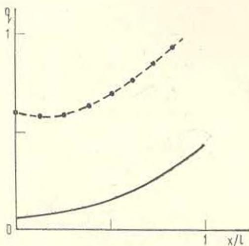
Фиг. 2. Зависимости малого параметра при сдвиге бетона ( $v l=0,1$  1/сут,  $\Lambda=0,033$  1/сут,  $t=50$  сут) от безразмерной координаты наращиваемого образца в линейной области (—) и нелинейной области (-•-)
