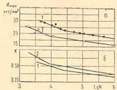
Фиг. 2. Усталостная диаграмма стеклопластика на эпокси-фенольном связующем при пульсирующем растяжении. 1.—СВАМ 5 : 1, 2.—СВАМ 1 : 1.
