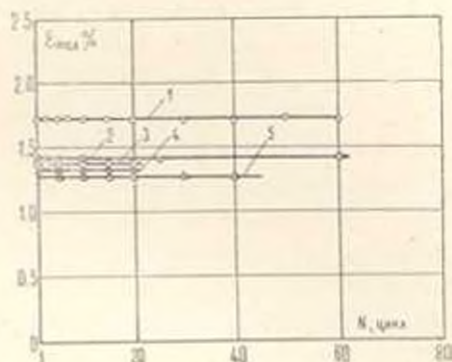
Фиг. 2. Влияние режима предварительного растяжения на циклическую деформативность стеклотекстолита ( \varphi = 0^\circ ). 1 — контрольная группа; 2 — \varepsilon_1 \rightarrow \varepsilon_2 ; 3 — \varepsilon_1 \rightarrow \varepsilon_3 ; 4 — \varepsilon_1 \rightarrow \varepsilon_4 ; 5 — \varepsilon_1 \rightarrow \varepsilon_5
