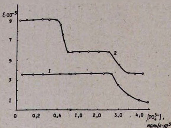
Рис. 4. Зависимость ОП исследуемых ацетоновых растворов от концентрации фосфат-иона при различной кислотности и концентрации молибдат-иона.
