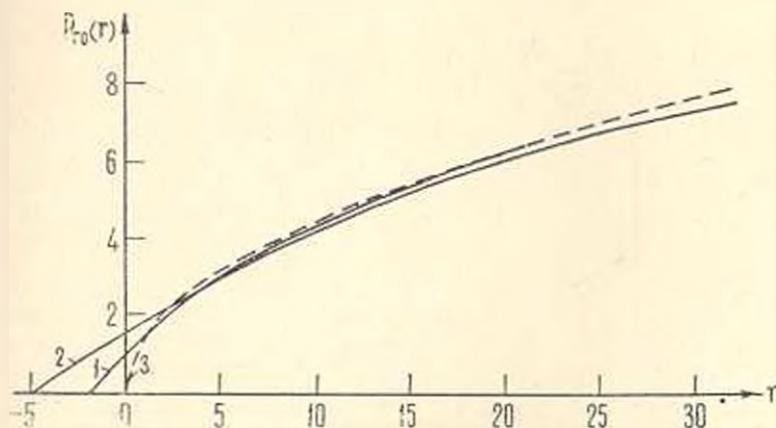
Фиг. 1. Распределение давления в зоне выхода. 1.  $\alpha_1 = -2, m = 0.25$ ; 2.  $\alpha_1 = -5, m = 0.25$ ; 3. по Герцу  $\frac{1}{2}r$ .
