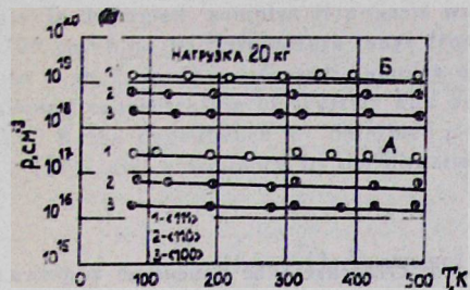
Рис. 2. Зависимость концентрации дырок в деформированных образцах p\text{-GaAs} : сплошные линии — теоретические, найденные по формуле (2), точки — экспериментальные данные, образцы те же, что и на рис. 1.
