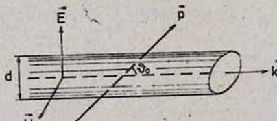
Рис. 1. Геометрия задачи: лазерный пучок с диаметром  $d$  и напряженностями электрического поля  $E$  и магнитного поля  $H$ , распространяющийся в направлении  $k$ , пересекает частица с импульсом  $p$  под начальным углом  $\vartheta_0$ .
