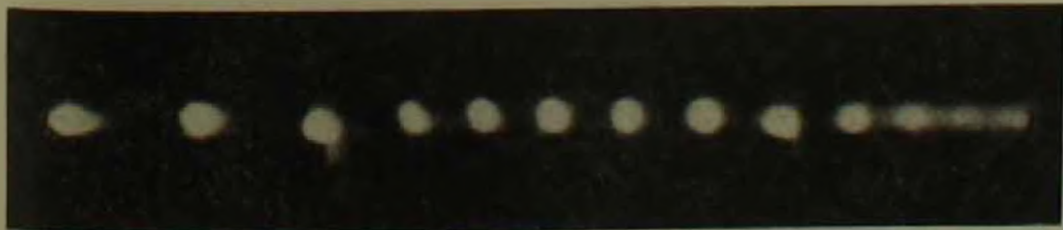
Рис. 1. Фотография страт в потоке газа. Направление потока слева направо. В области первых трех страт V_1=250 м/сек, следующих шести— V_2=100 м/сек
