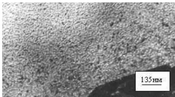
Рис. 1. Электронная микрофотография эжектированных наночастиц  $\text{MoO}_3$
