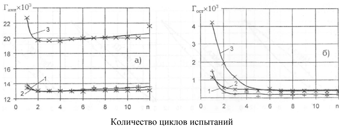
Рис. 2. Кривые изменения интенсивностей амплитудных (а) и остаточных (б) деформаций сдвига в зависимости от номера цикла испытаний стеклопластиковых труб на повторно-статическое одноосное растяжение (1), кручение (2) и кручение с растяжением при простом нагружении (3).
