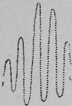
Рис. 4. Микрофотометрическая запись распределения интенсивности полос смещения при ширине выходной щели коллиматора 30 мкм. Фотопластинка расположена в плоскости P_1 .
