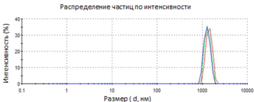
Рис. 3. Распределение частиц бентонита по размерам (0.4 г Ca(OH)<sub>2</sub> на 1 г бентонита).
