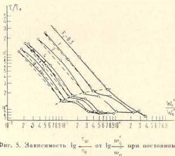
Фиг. 5. Зависимость  $\lg \frac{\tau}{\tau_0}$  от  $\lg \frac{w}{w_0}$  при постоянных числах Фруда.
