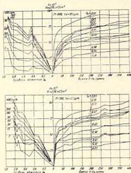
Фиг. 5. Опытные графики средних по группе образцов относительных деформаций ползучести неизолированных бетонов М-600 и 700 и вызванных ими потерь напряжений арматуры и функции времени и начального уровня обжатия.
