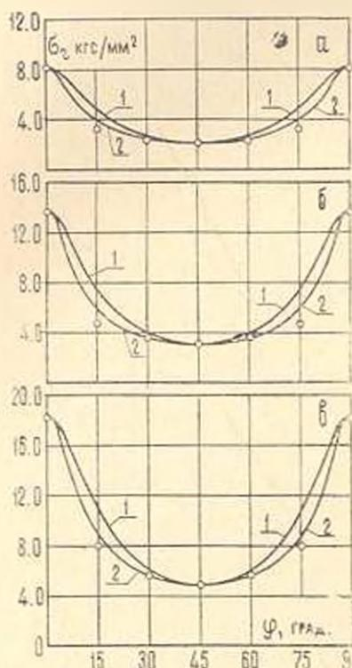
Фиг. 5. Анизотропии усталостной прочности стеклопластика СВМ 1:1 при  $N = 10^6$  циклов: 1. рассчитанная по формуле (5), 2. — по формуле (6), а)  $r = 1$ , б)  $r = 0$ , в)  $r = \infty$ .
