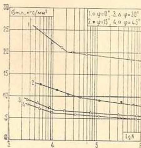
Фиг. 3. Усталостные диаграммы стеклопластика СВММ 1:1 при пульсирующем сжатии ( $r = -\infty$ ).
