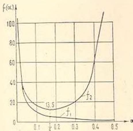
Фиг. 2. Графики функций  $f_1(\alpha)$  и  $f_2(\alpha)$ , характеризующих коэффициенты сдвига  $K_{yy}$  и  $K_{\omega\omega}$ .
