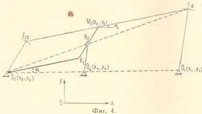
В последнем случае параметры механизма вычисляются из пропорциональности отрезков (фиг. 4) нижеследующими соотношениями:
