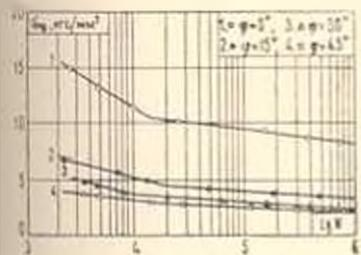
Фиг. 1. Усталостные диаграммы стеклопластика СВММ 1:1 при асимметричном растяжении-сжатии ( $r = -1$ ).
