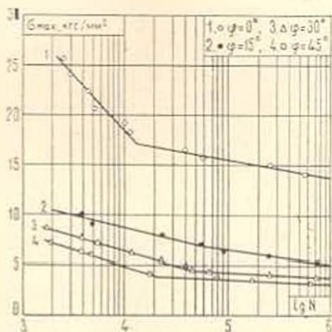
Фиг. 2. Усталостные диаграммы стеклопластика СВММ 1:1 при пульсирующем растяжении ( $r = 0$ ).
