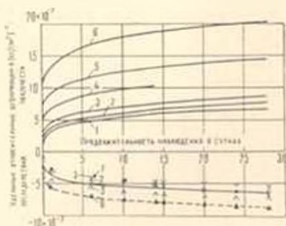
Фиг. 3. Сопоставление удельных деформаций ползучести бетонных образцов, загруженных в возрасте  $t_1 = 272$  сут., с удельными деформациями последействия образцов-близнецов, разгруженных в возрасте  $t_2 = 328$  сут.
