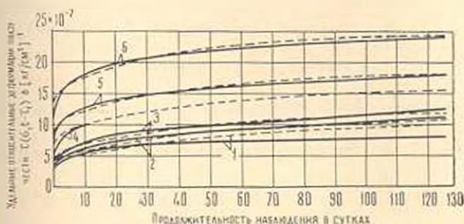
Фиг. 1. Экспериментальные кривые удельных деформаций ползучести бетона (сплошные линии), нагруженного в возрасте  $\tau_1 = 272$  сут., и теоретические кривые (пунктирные линии), рассчитанные на основе (1) с учетом (5) — (8).
