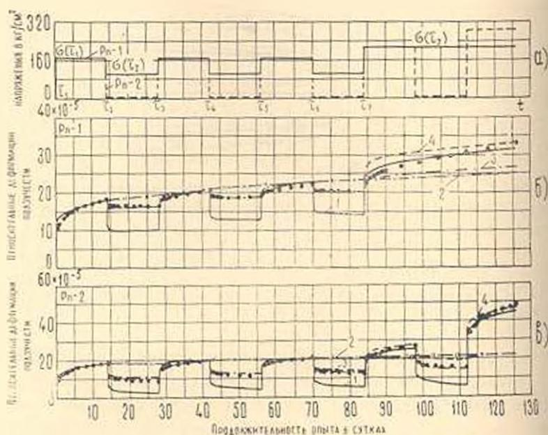
Фиг. 4. Режим загрузки образцов (а) и деформации ползучести (б) и (в) при периодических ступенчато-изменяющихся напряжениях. 1—теоретические кривые деформаций, рассчитанные на основе выражения (9); 2—то же—на основе (10); 3—то же—на основе (13); 4—то же—на основе выражений, аналогичных (14) (экспериментальные значения деформаций обозначены точками).
