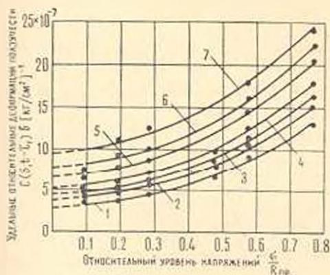
Фиг. 2. Кривые зависимости удельных деформаций ползучести бетона, нагруженного в возрасте  $\tau_1 = 272$  сут., от уровня напряжений  $\frac{\sigma}{R_{np}}$ .
