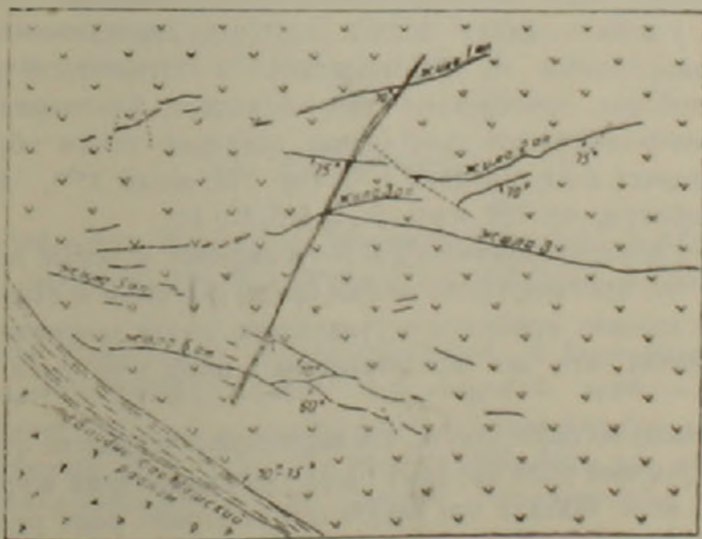
Рис. 2. Штольня «Саралых»-2, гор. 1009 м. 1—плагноклазовые порфиристы, 2—диабазовые дайки; 3—рудные жилы, 4—тектонические нарушения, 5—предполагаемые продолжения рудных жил
