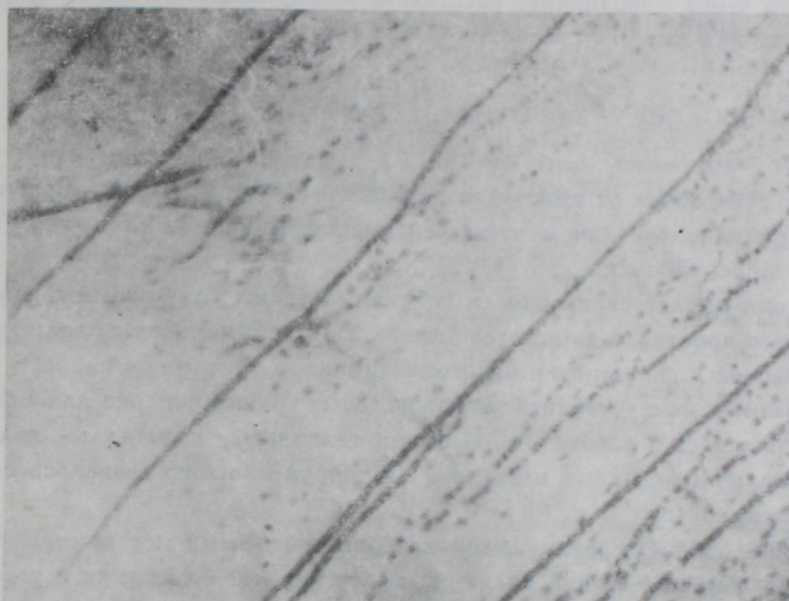
Рис. 4. Полигональная структура, наблюдаемая на поверхности изогнутого при \tau=400 \text{ Г/мм}^2 , а затем отожженного кристалла (время отжига — 10 часов).
