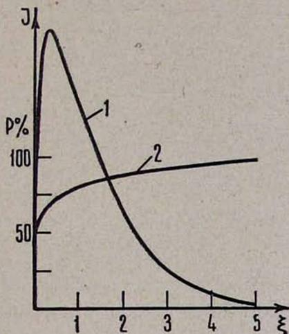
Рис. 1. Спектральное распределение синхротронного излучения в произвольном масштабе (кривая 1) и степень поляризации синхротронного излучения в процентах (кривая 2) в зависимости от безразмерной частоты  $\xi = \omega/\omega_c$ , где
