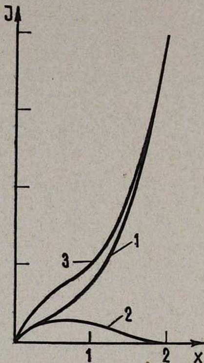
Рис. 4. Спектральные распределения продольно и поперечно поляризованных компонент модулированного излучения (кривые 1 и 2 соответственно). Кривая 3 — спектральное распределение полного излучения. Поляризации определены как в пункте 4.
