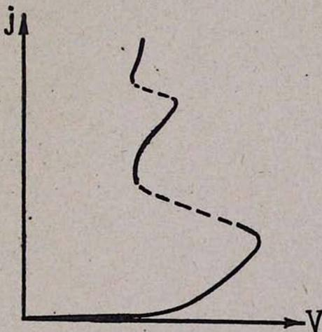
Рис. 3. Схематическое изображение прямой ветви вольт-амперной характеристики  $p^+nl^+$ -структуры.
