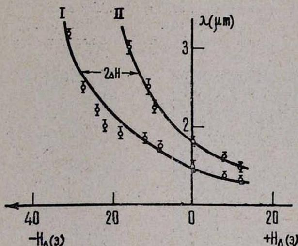
Рис. 5. Изменение длины волны ряби намагниченности под действием перемагничивающего поля: I —  $\vec{H}_A \uparrow \downarrow \Delta \vec{H}$ , II —  $\vec{H}_A \uparrow \uparrow \Delta \vec{H}$ .
