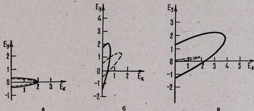
Рис. 3. Эллипс поляризации при различных значениях  $x$  и  $r$ : а)  $x = 0$ , б)  $x = 0,4$ , в)  $x = 0,8$ . Сплошные кривые соответствуют  $r = 0$ , пунктирные —  $r = 0,4$ . Все кривые представлены для случая  $\alpha = 0,5$ .
