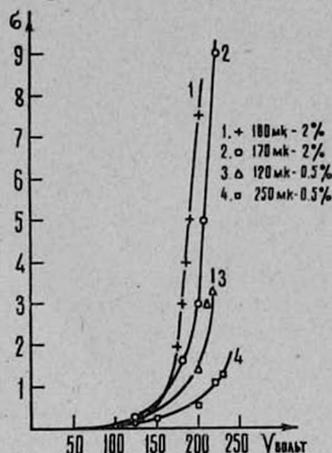
Рис. 1. Зависимость  $\sigma = f(V)$  для слоев с касанием. Кривая 1 — толщина 100 мк, плотность 2%. Кривая 2 — толщина 170 мк, плотность 2%. Кривая 3 — толщина 120 мк, плотность 0,5%. Кривая 4 — толщина 250 мк, плотность 0,5%.
