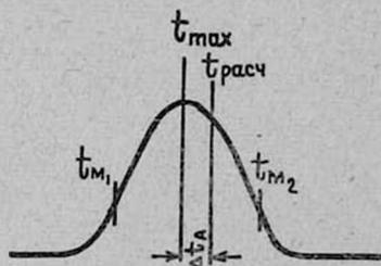
Рис. 1. Прохождение источника через диаграмму направленности антенны;  $t_{N_1}$ ,  $t_{N_2}$  — метки времени,  $t_{\text{max}}$  — момент максимального сигнала,  $t_{\text{расч.}}$  — расчетное время максимального сигнала.
