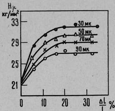
Рис. 5. Зависимости величины  $H_M$  от деформации при постоянной нагрузке.
