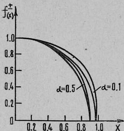
Рис. 1. Зависимость „диаметров пучков“  $f_{\pm}$  от расстояния
