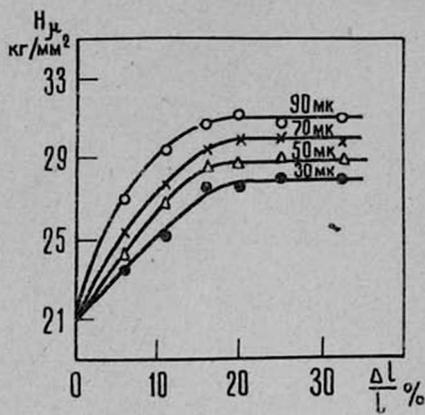
Рис. 6. Зависимости величины  $H_M$  от степени деформации при постоянном времени до разрушения.
