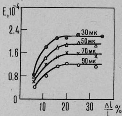
Рис. 2. Зависимости величины  $E$  от деформации при постоянной нагрузке.
