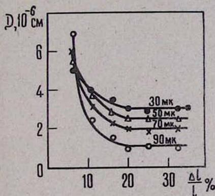
Рис. 3. Зависимости величины  $D$  от деформации при постоянном времени до разрушения.
