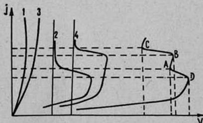
Качественные ВАХ  $p$ - $n$ -переходов и структуры. Кривые 1–4 соответствуют напряжениям  $V_1 \div V_4$ .
