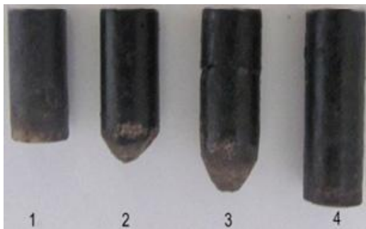
Рис. 4. Изменение геометрической формы фронта от времени. Время: с (начало отсчета соответствует точке 1 на рис. 3) 0 – 1, 20 – 2, 40 – 3 и 50 – 4.
