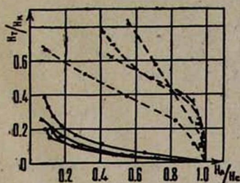
Рис. 3. Критические кривые сползания (сплошные) и переключения (пунктирные) для гладких пленок различной толщины; \bullet — 61 (0,55 мкм); \times — 65 (1,28 мкм); \blacktriangle — 64 (1,1 мкм); \circ — 67 (2,1 мкм).
