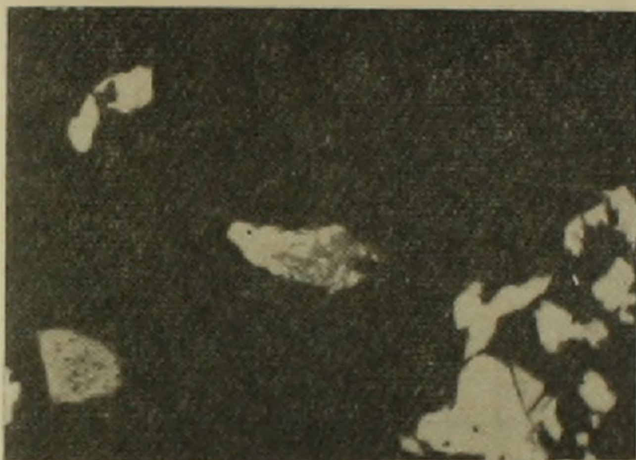
Фиг. 1. Хизлевудит в тесных срастаниях с аварунтом—зерно в центре. Светлый—аварунт, серый—хизлевудит. В левом нижнем углу—зерно хромшпинелида. Аншлиф, ув. в 20 раз.
