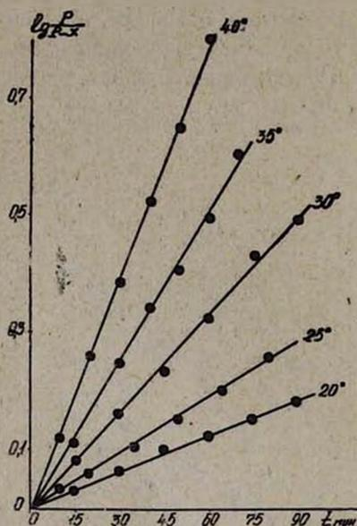
Рис. 3. Зависимость  $\lg \frac{P}{P-x}$  от времени при барботаже воздуха при разных температурах. Условия опытов:  $(P)_0 = 0,005$  моль/л и  $(A)_0 = 0,05$  моль/л.
