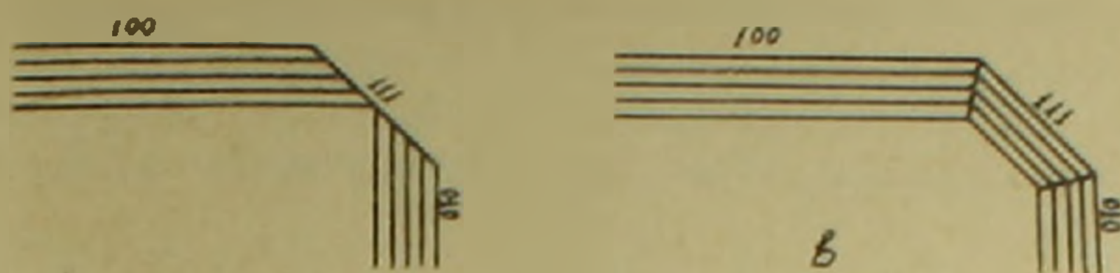
Фиг. а—грань октаэдра (грань торможения), образуемая торцами граней куба; б—грань октаэдра, растущая последовательным нарастанием слоев.
